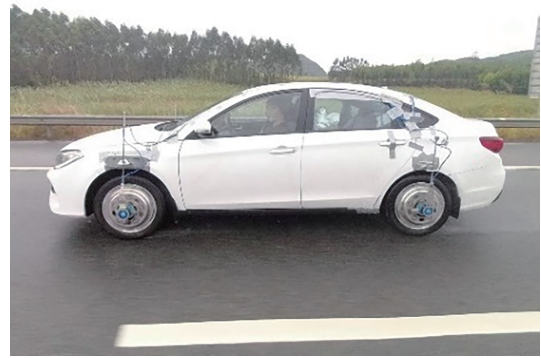
图3 实车装配传感器及测试场景
