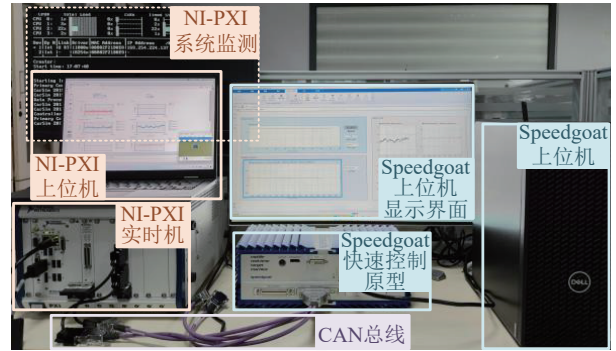
图5 硬件在环试验平台
