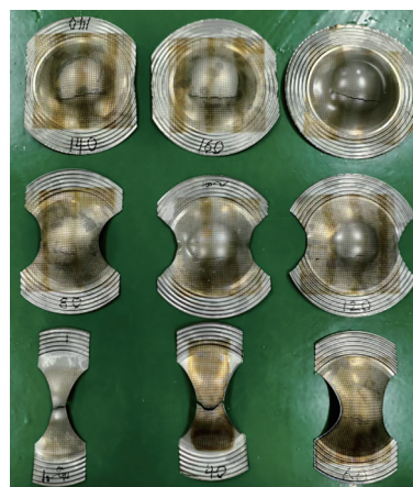
图4 成形极限检测样品图
