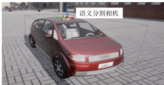
图11 智能车传感器安装
