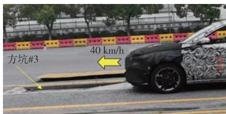
图27 改进后的车身方坑#3道路试验
