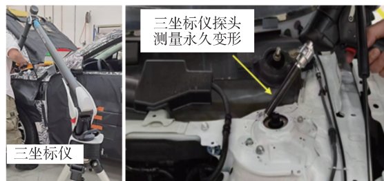
图7 三坐标仪测量避震塔平台法向永久变形
