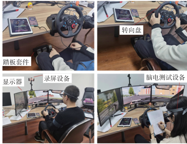
图1 驾驶模拟试验设备
