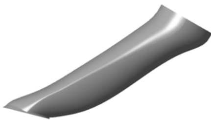
图14 高滚流弯刀型气道
