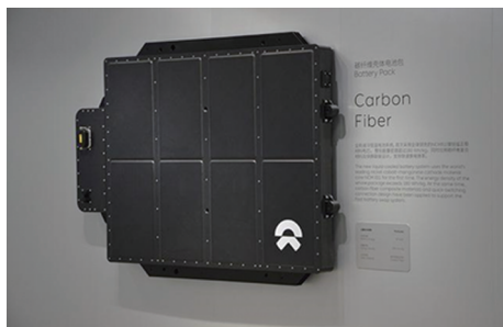
图10 蔚来前瞻研发的碳纤维壳体电池包 [31]
