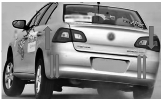
图2 汽车左转时的运动状态
