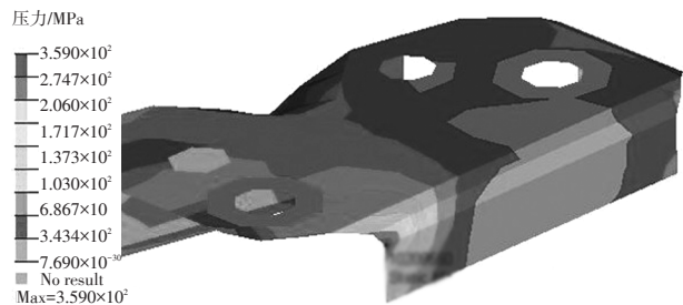
图6 稳定杆支座极限强度应力分布云图 [25]
