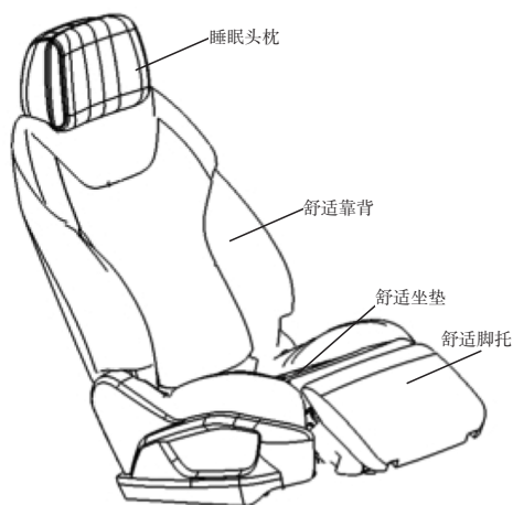
图1 零重力座椅结构
