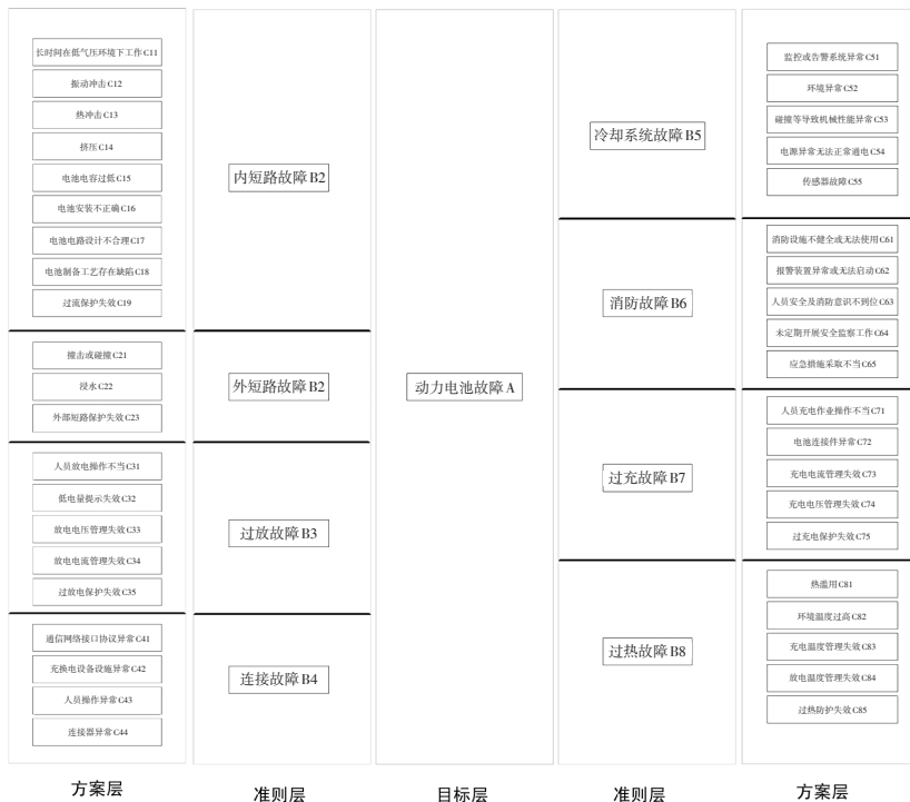
图2 动力电池故障层次分析模型
