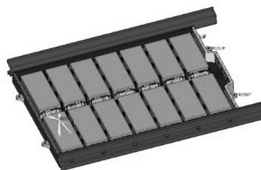
图3 电池总成有限元前处理
