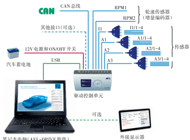
笔记本电脑(AVL-DRIVE软件) 外接显示器 注:A1、A2、A3和I1为传感器接口,RPM(Revolutions Per Minute)为轮速传感器。
