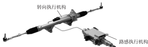
图3 线控转向系统结构示意图
