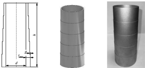
注: d 为内径; t_{max} 为最大壁厚; h 为薄壁管高度; a 为梯度厚度值。
