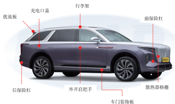
图1 红旗某车型外饰非金属喷涂零部件分布情况
