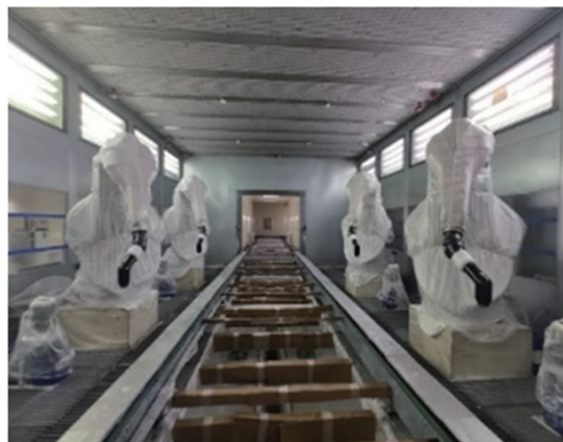
图3 配合滑橇输送线使用的喷涂机器人
