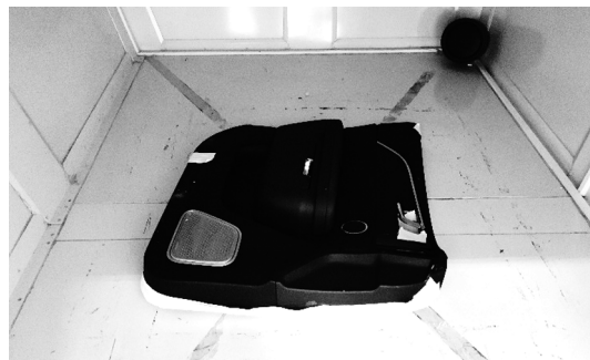
图5 小型混响室吸声系数测量示意
