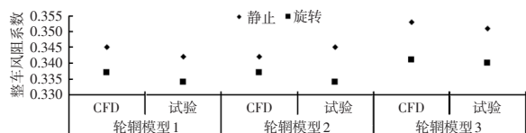
图6 不同轮辋模型的整车风阻系数影响量仿真与试验结果对比
