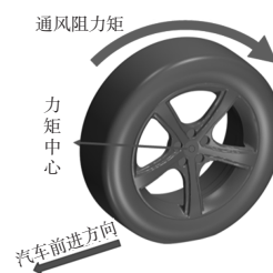
图10 车轮通风阻力矩示意
