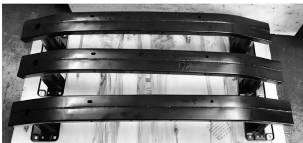
图7 超高强钢热辊弯前防撞梁 [20]
