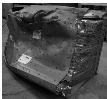
图3 实车试验壁障变形示意
