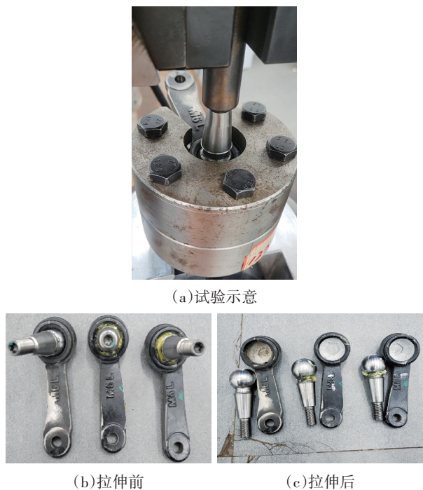
图10 摆臂球头破坏试验
