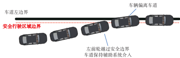
图4 车道保持辅助系统介入过晚示意
