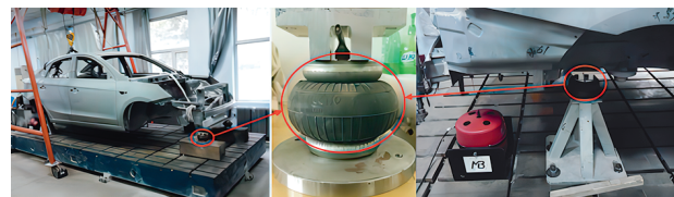
图4 白车身低阶模态试验工况
