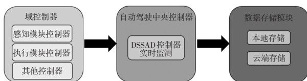
图9 中央控制器集成DSSAD数据记录流程
