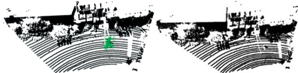
(a)相机视角下的原始点云 (b)提取目标后的剩余点云
