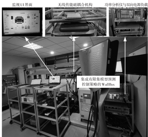
图7 电动汽车无线充电系统整机测试平台
