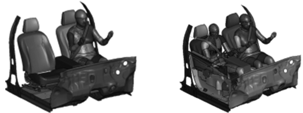
(a)单乘员台车模型 (b)双乘员台车模型
