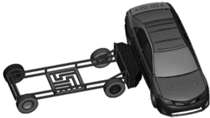
图4 AE-MDB侧面碰撞模型
