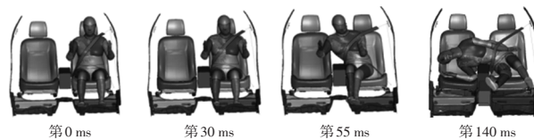
图17 单乘员AE-MDB侧面碰撞老年人体模型运动学响应
