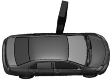
图5 侧面斜柱碰撞模型
