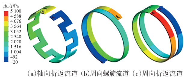
图7 不同流道类型的冷却油压力分布
