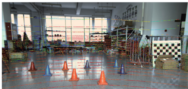
图19 激光雷达与相机外参标定效果
