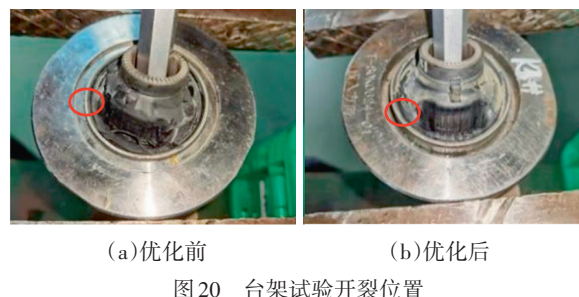
图20 台架试验开裂位置
