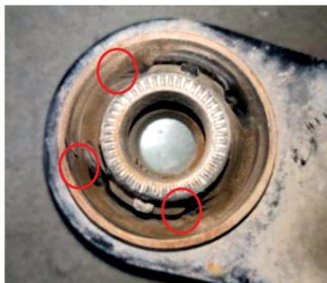
图11 路试开裂位置
