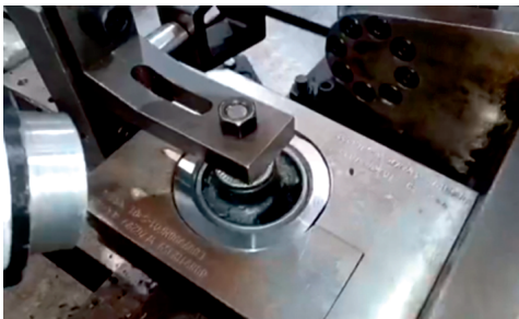
图 16 衬套块谱台架试验
