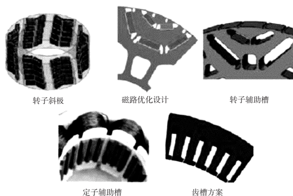
图4 分段斜极定、转子辅助槽电磁噪声优化方案
