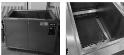
(b) 水热法制备超疏水换热器试验装置
