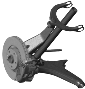
图3 制动系统复模态分析有限元模型
