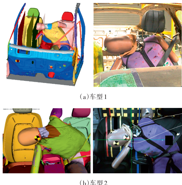
图1 2款模型仿真与试验结果对比示意
