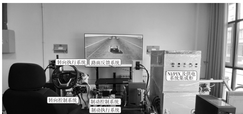
图8 硬件在环测试平台各组成部分
