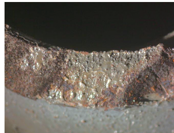
图4 断裂失效螺栓套断面油漆宏观形貌
