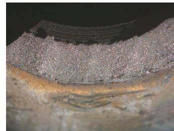
图5 断裂失效螺栓套宏观脆性断口形貌
