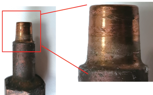
图5 电极臂端面材料粘连
