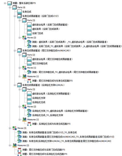
图 14 3DCS 整车后部多层次基准公差建模
