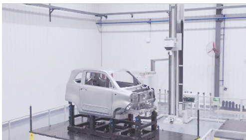
图 19 车身主基准下的三坐标测量
