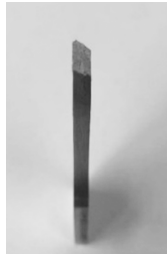
(b)拉伸断后试样断裂面角度成近似45°
