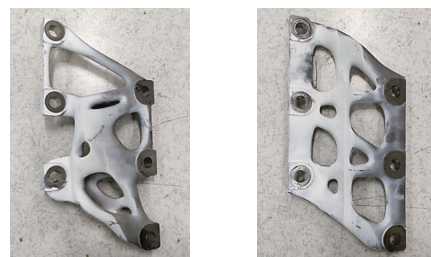
图16 台架试验后的优化支架
