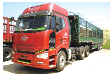
图 6 解放 J6P 标载牵引车路谱采集
