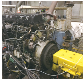
图 5 柴油机耐久试验台架
