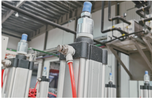
图 11 气缸保压夹紧验证
