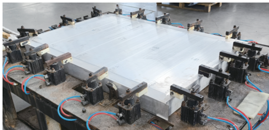
图2 转角下压式气密工装
