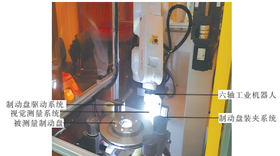
图6 制动盘表面缺陷检测试验
