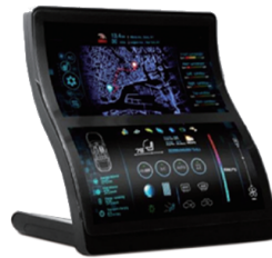
(c)9.4英寸柔性Micro-LED中控车截屏
