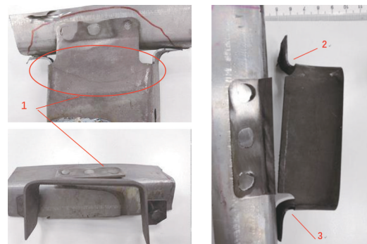
图 15 前地板后横梁失效件
