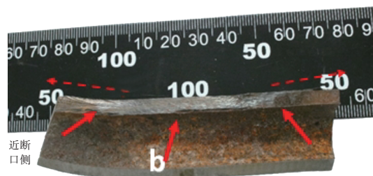
图11 轴向断口实物
