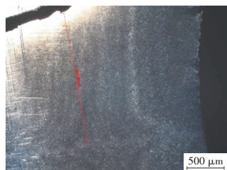
图7 轴向裂纹与焊缝距离
