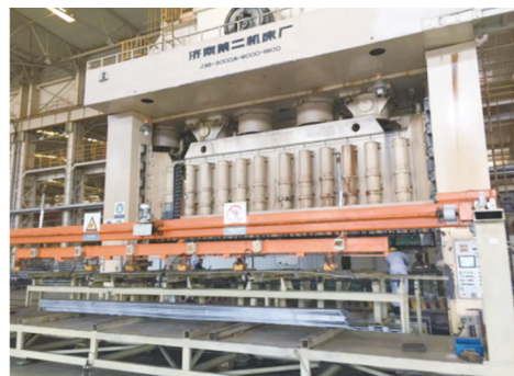
图3 国内某3 000 t纵梁压机
