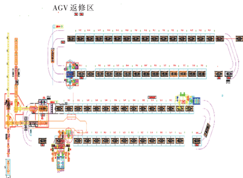
图1 数字孪生系统(AGV生产线)总体架构
