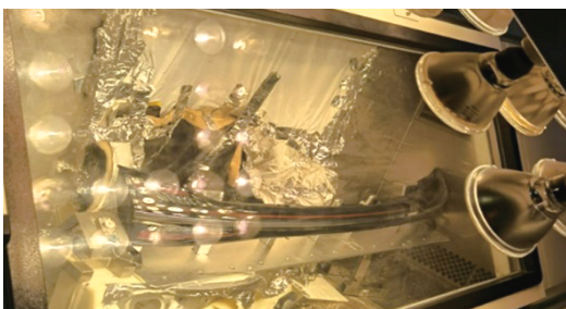
图7 模拟阳光暴晒试验
