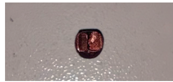
图 11 强度测试后的环形光斑激光焊试件剪切强度的计算公式为:
