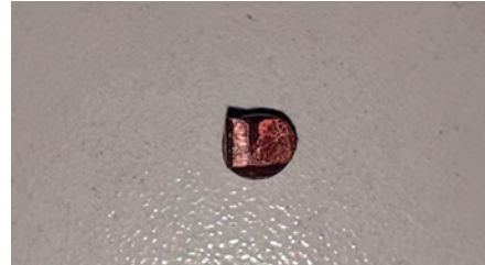
图 20 强度测试后的 TIG 焊试件
